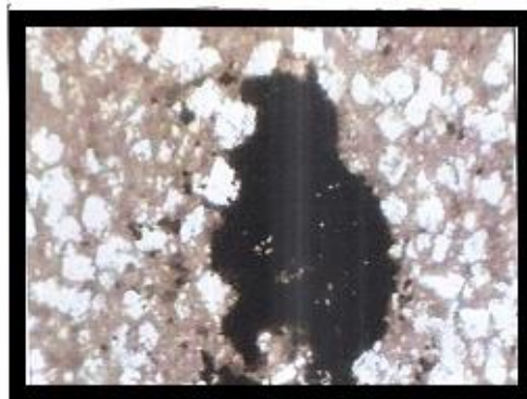
Bioclast : Rudist Porosity : Intragranular Scale : 5*5 Depth : 2759-2763m
