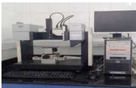
شکل ۵) دستگاه DSA100 شرکت KRÜSS آلمان
