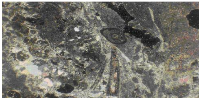
شکل ۶- پکستون بیوکلاستی همراه با قطعات بیواسپارایت پراکنده تخلخل حفرهای و قالبی
