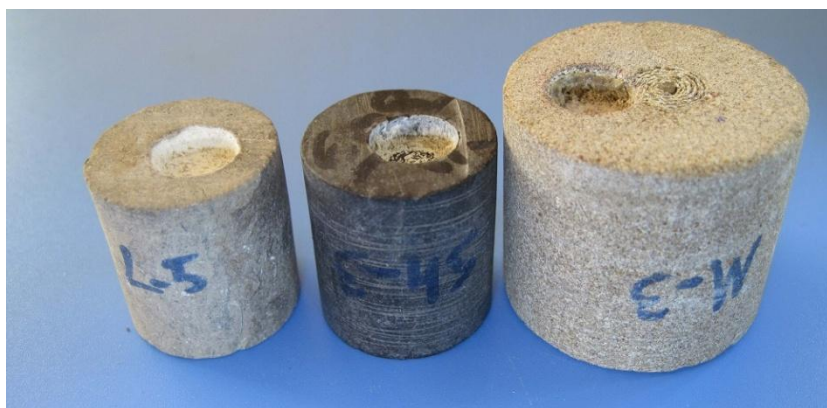
شکل ۲- نمونه سنگ‌های مورد آزمایش (از راست به چپ: ماسه سنگ، سنگ شیل، سنگ آهک)
