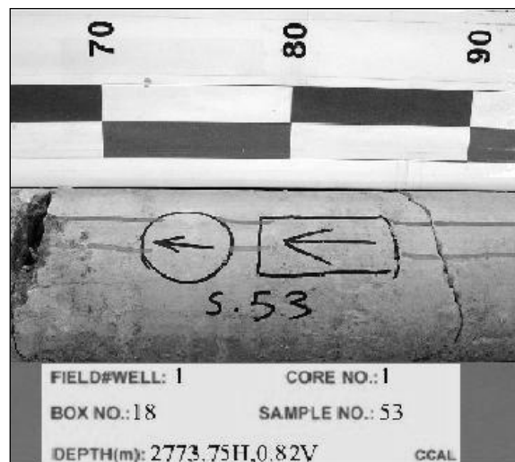
شکل ۲- موقعیت نمونه‌های افقی و عمودی به شکل پلاگ با قطر ۳/۸ سانتی متر و طول حدود ۵ سانتی متر
