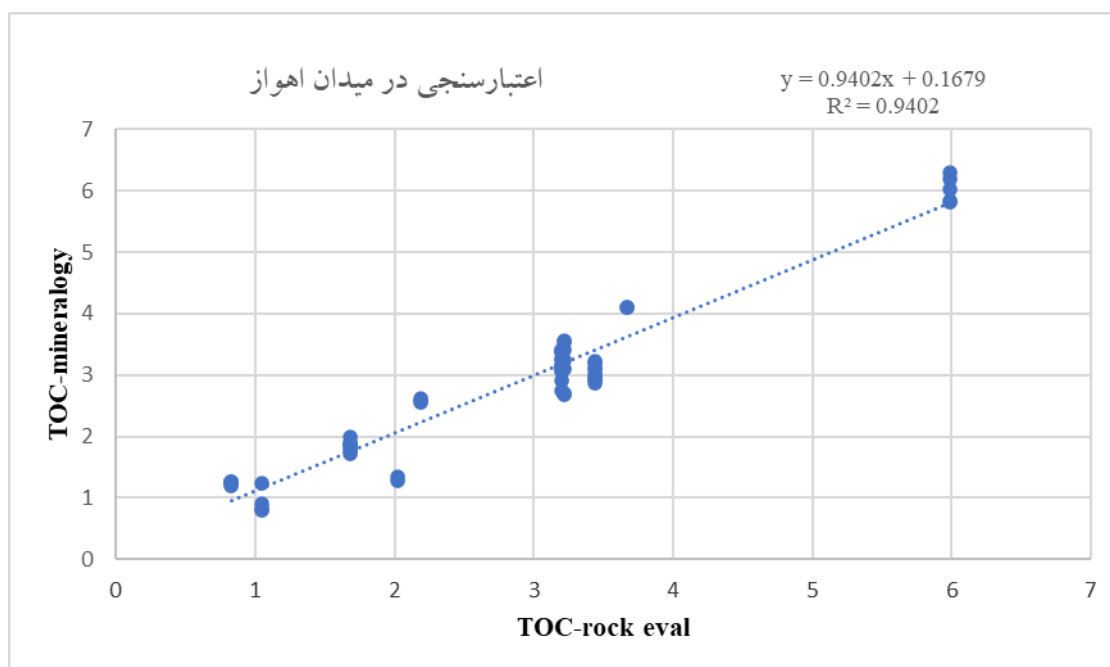
شکل ۱۰- بررسی میزان ارتباط و همبستگی TOC حاصل از روش داده های کانی شناسی و TOC واقعی در میدان اهواز
